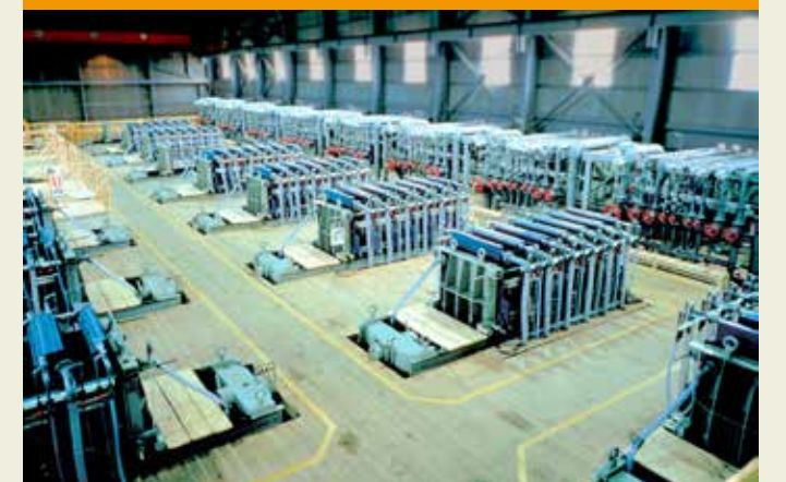
海水濃縮製塩 CS-5型 電気透析槽 (1,800対) / 9,280m 2 CS-5 electrodilator (1,800 cell pairs) / 9,280m 2
