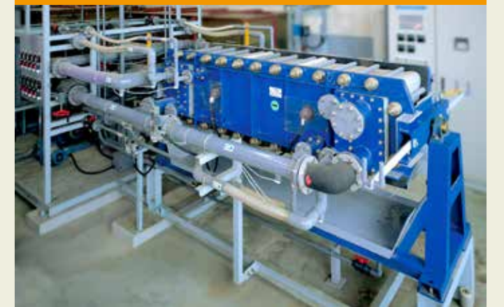
工程排水脱塩 DB-4型 電気透析槽 (320対) / 770m 2 DB-4 electrodilator (320 cell pairs) / 770m 2
